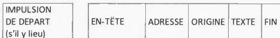
Figure 4-2. Forme de transmission — Exploitation par téléimprimeurs (cf. 4.4.10.1.2)
