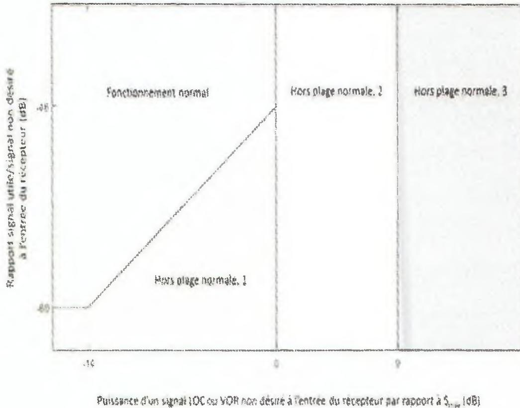
Note. — La partie de la figure marquée « Fonctionnement normal » est celle dans laquelle le § 3.6.8.2.2.6.4 s'applique et, par conséquent, les exigences du § 3.6.8.2.2.3 sont respectées ( $MFR \leq 0,001$ ). La limite inférieure de cette partie correspond à la ligne qui représente le rapport minimal acceptable signal utile/signal non désiré spécifié au § 3.6.8.2.2.6.4 en fonction de la puissance non désirée, pour les valeurs de la puissance non désirée jusqu'à  $S_{max}$ .
