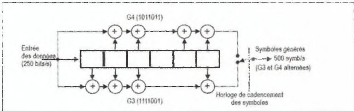
**Figure B-11. Codage à convolution**
