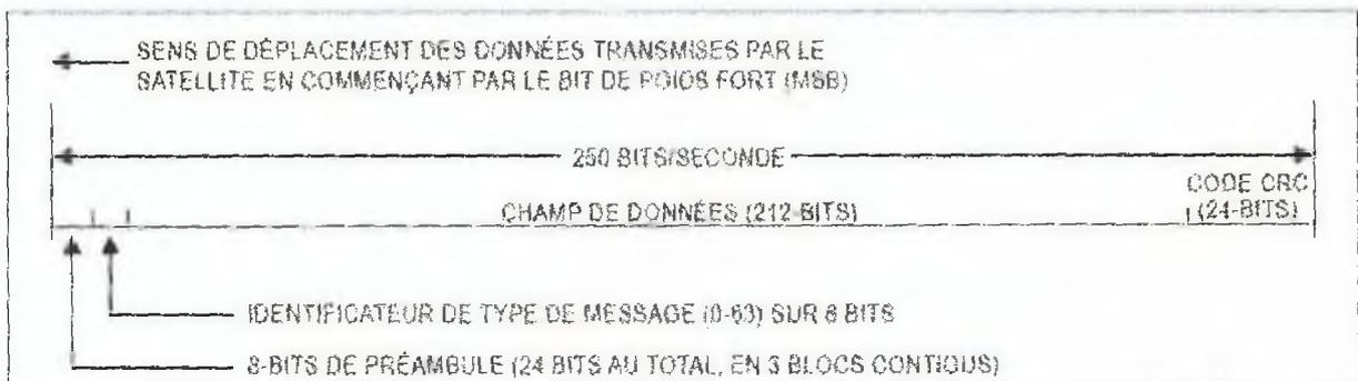
**Figure B-12. Format des blocs de données**
